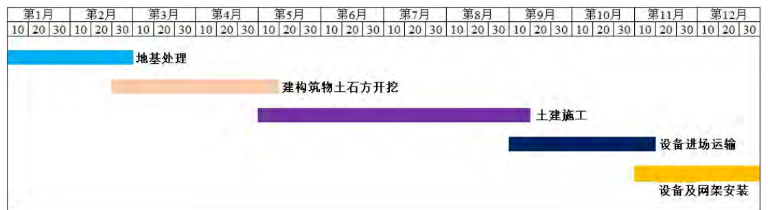
图 12 变电站新建工程施工时序图
