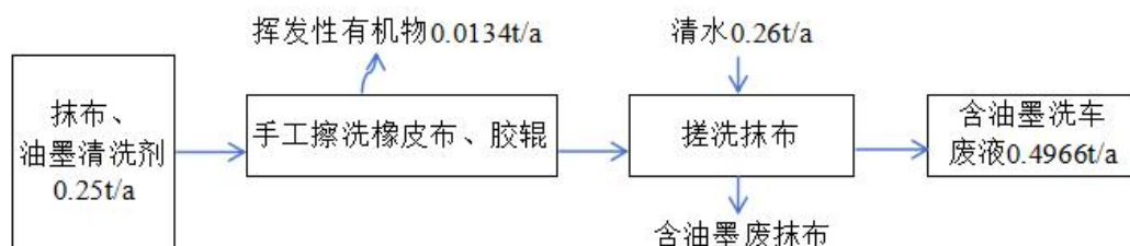
图 2-1 含油墨洗车废液产生流程
