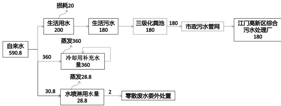
图 2-1 本项目水平衡图 (t/a)
