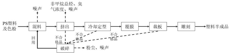
图 2-2 塑料半成品生产工艺流程图及产污环节
