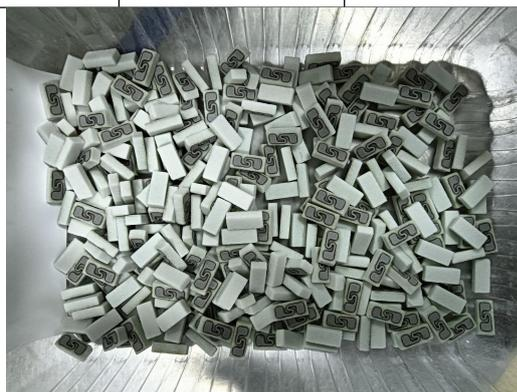
图 2-1 陶瓷发热体照片
