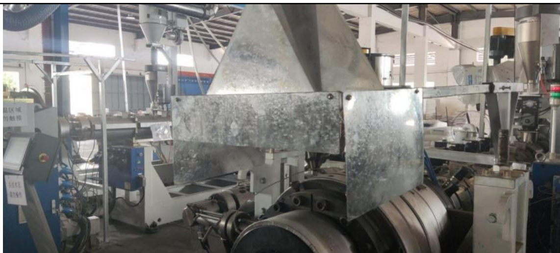
图4-1 挤塑机半密闭罩示意图
