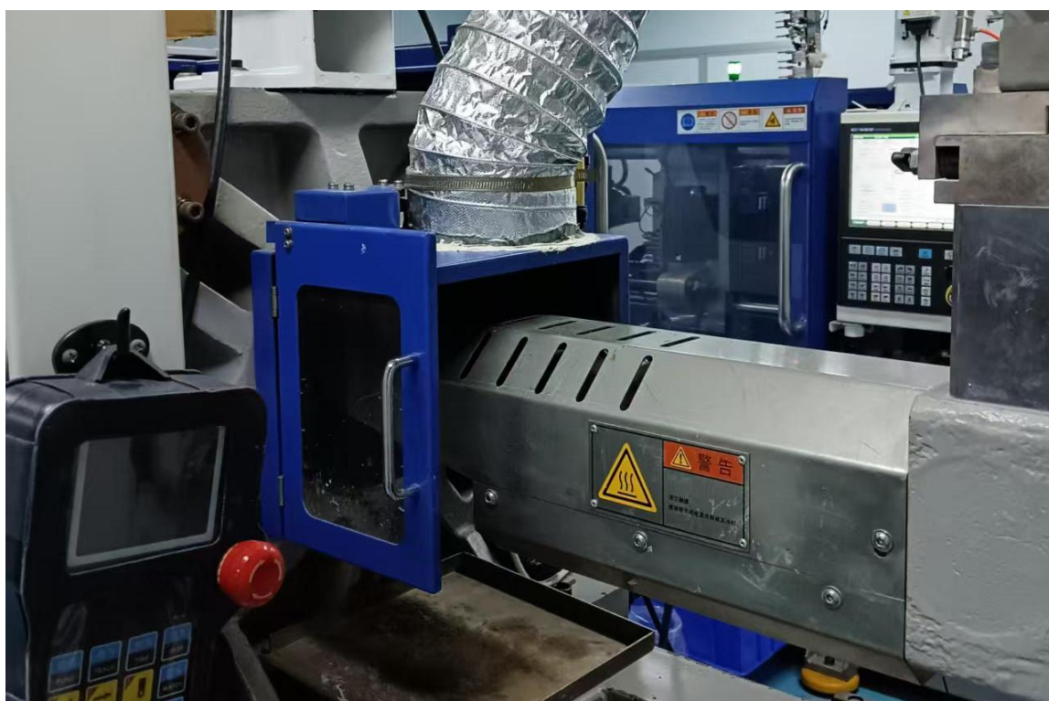
图4-2 注塑机半密闭罩示意图
