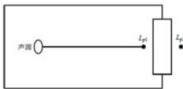
图 9 室内声源等效为室外声源图例
