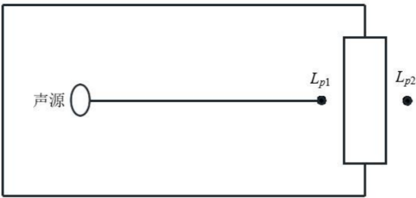
图 6.3-1 室内声源等效为室外声源图例
