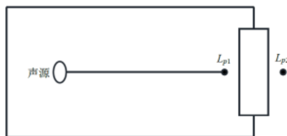
图 5.4-1 室内声源等效为室外声源图例
