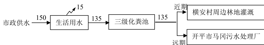
图 2-1 项目水平衡图 (单位: t/a)
