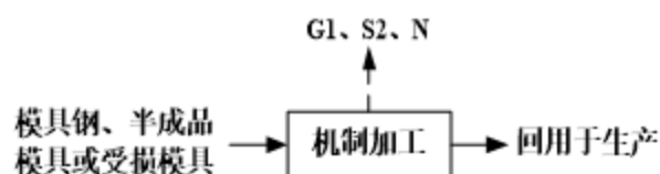
图2-4 模具生产及维修工艺流程及产污环节图
