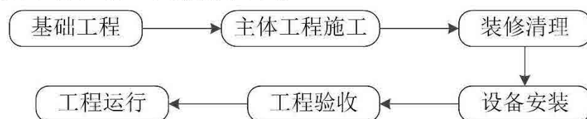
图 3.4-1 污水处理厂施工期工艺流程图
