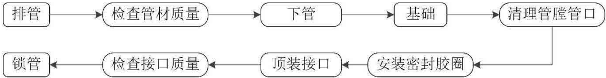
图 3.4-3 管道安装工艺流程图
