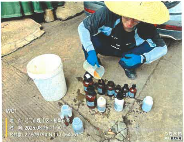
WC1-样品装瓶
