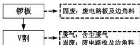
图23 成型V割工艺流程图
