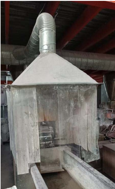
图4. 注塑、挤出废气收集措施示意图
