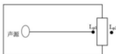
图 5.2-22 室内声源等效为室外声源图例
