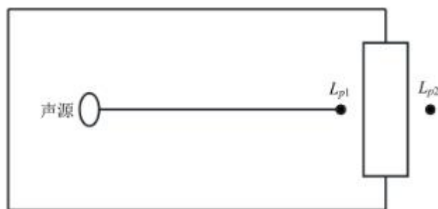
图 5.2.4-1 室内声源等效为室外声源图例
