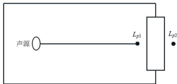
图 6.4-1 室内声源等效为室外声源图例
