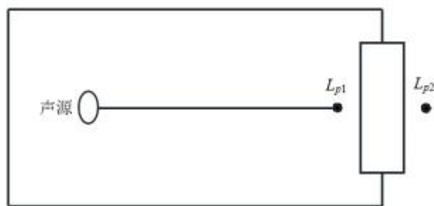
图 7.3-1 室内声源等效为室外声源图例
