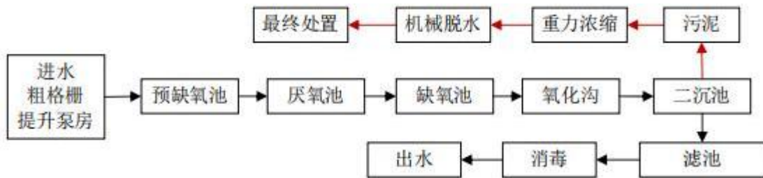
图 4-2 开平市新美污水处理厂水处理工艺流程图
