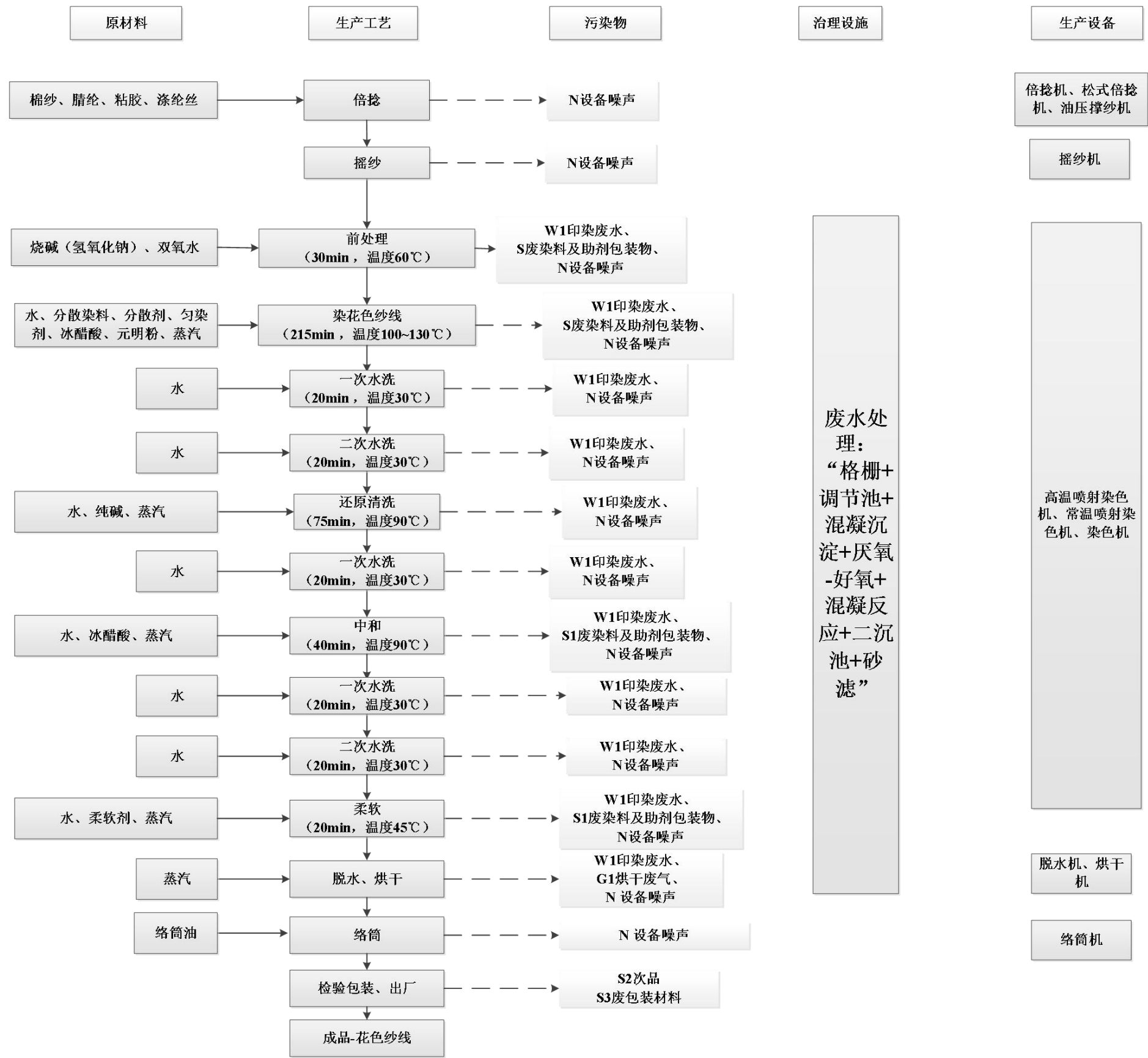
图 4.2-3 花色纱线工艺流程
