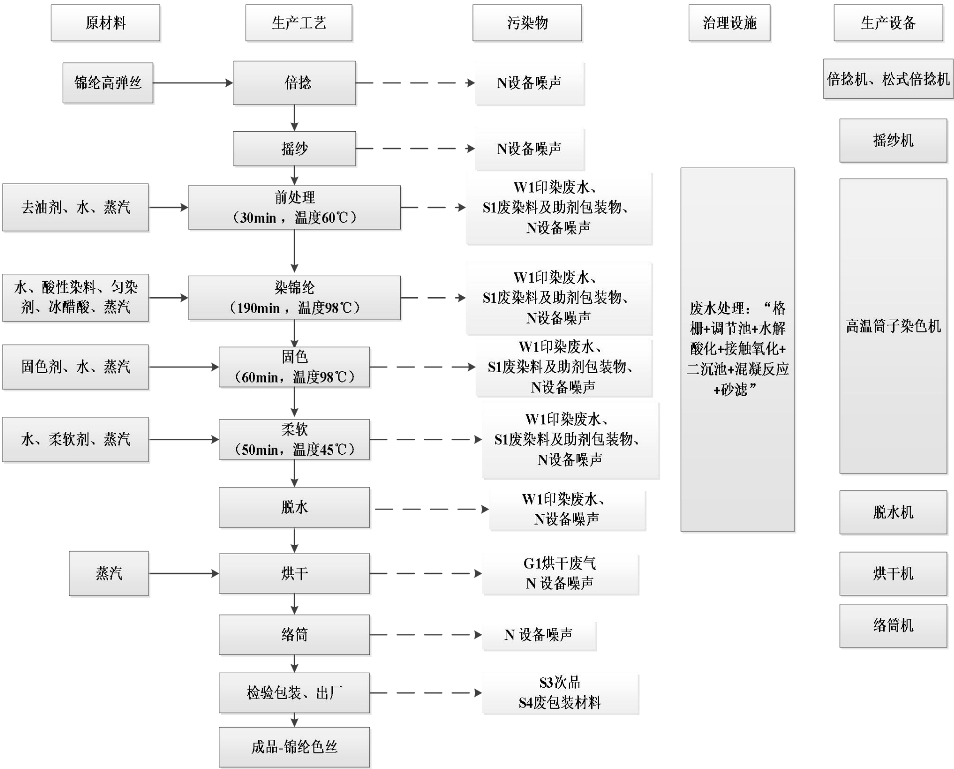
图 3.2-1 锦纶色丝工艺流程图
