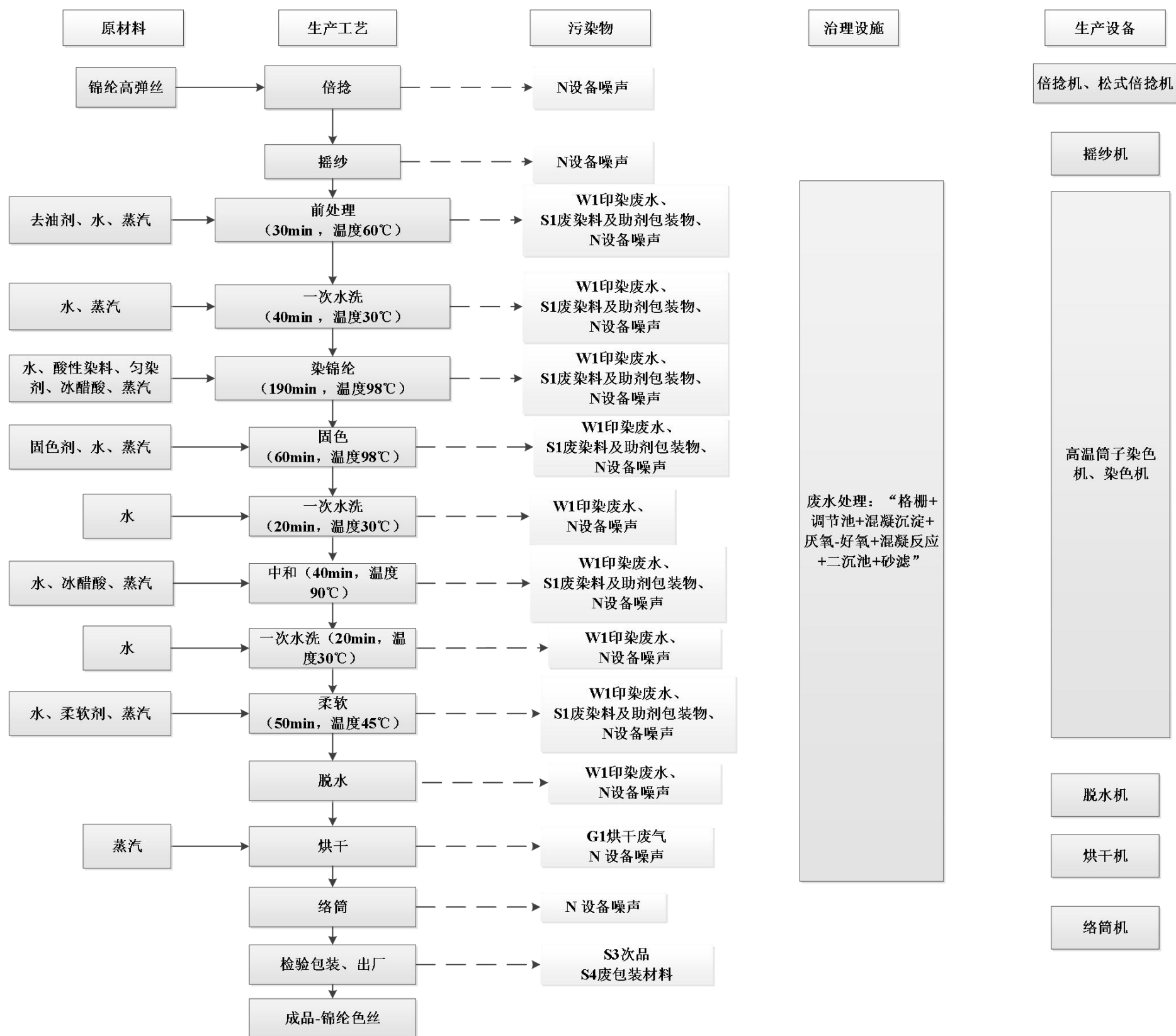
图 4.2-1 锦纶色丝工艺流程图
