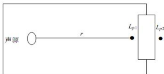
图4-5 室内声源等效为室外声源图例
