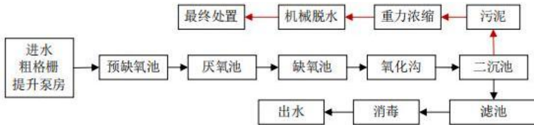
图 4-1 开平市新美污水处理厂水处理工艺流程图
