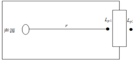
图4-7 室内声源等效为室外声源图例
