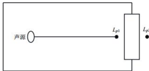
图 4-2 室内声源等效为室外声源图例
