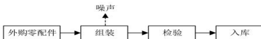
图 2-7 灯具生产工艺流程及产污环节图
