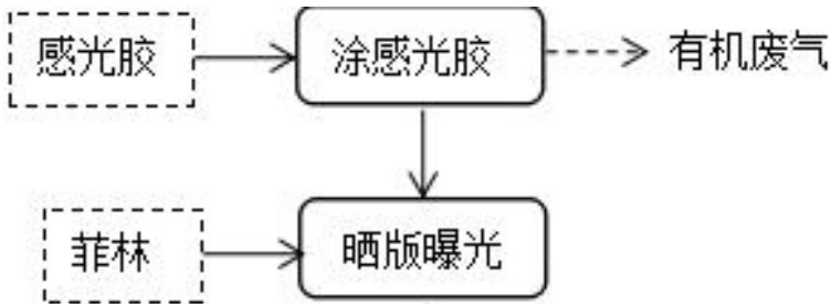
图 7 丝网版制版流程图
