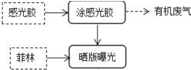
图 7 丝网版制版流程图
