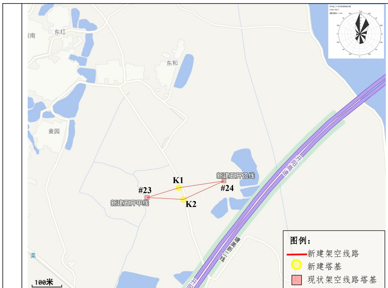
图 2-2 线路改迁后线路接线示意图
