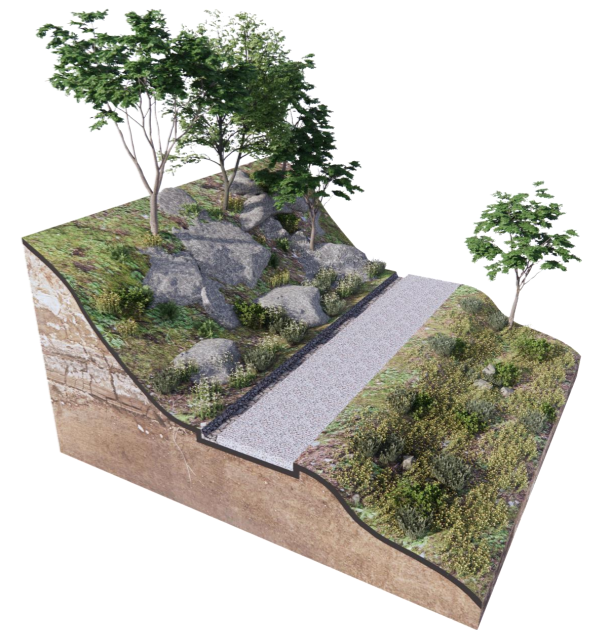
LBZ4：露骨料混凝土路
