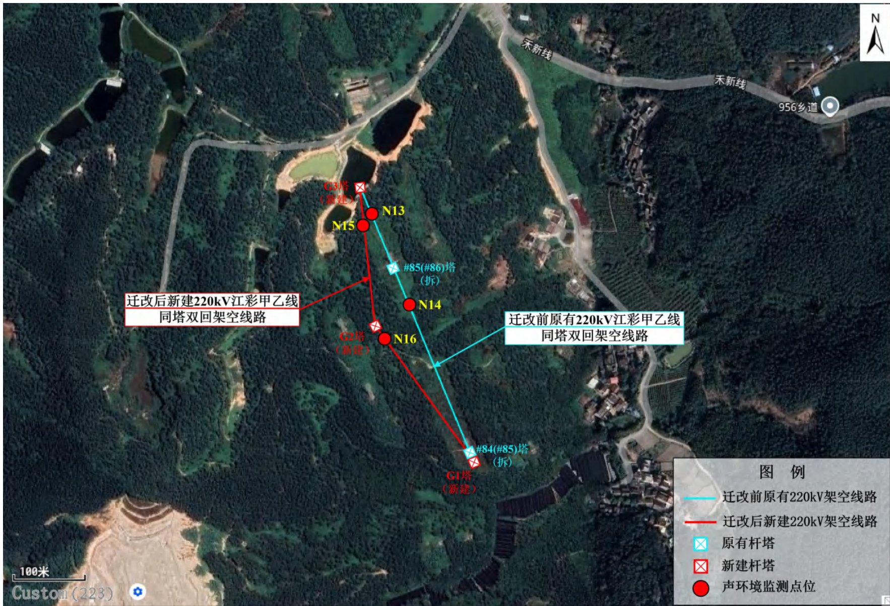
图 3-5 本工程声环境现状监测布点图-220kV 江彩甲乙线#84（#85）～#86（#87）段迁改工程
