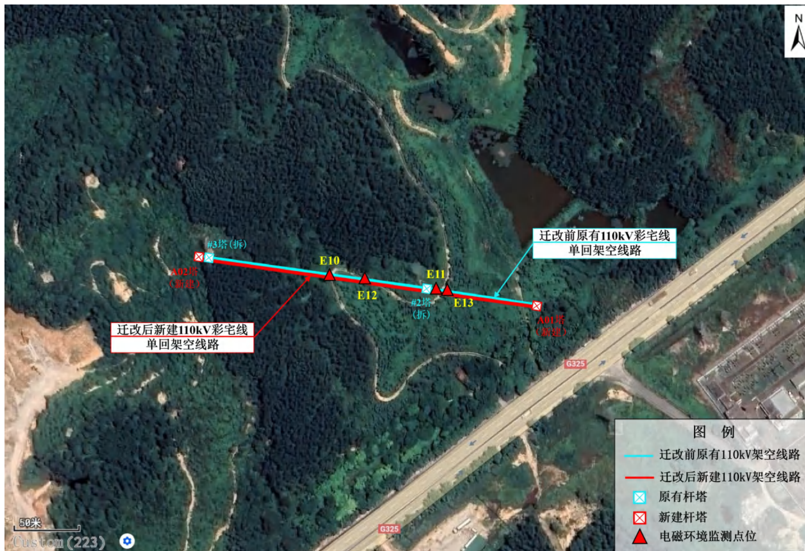
图I-3 本工程电磁环境现状监测布点相对位置示意图-110kV 彩宅线#1~#3 段迁改工程
