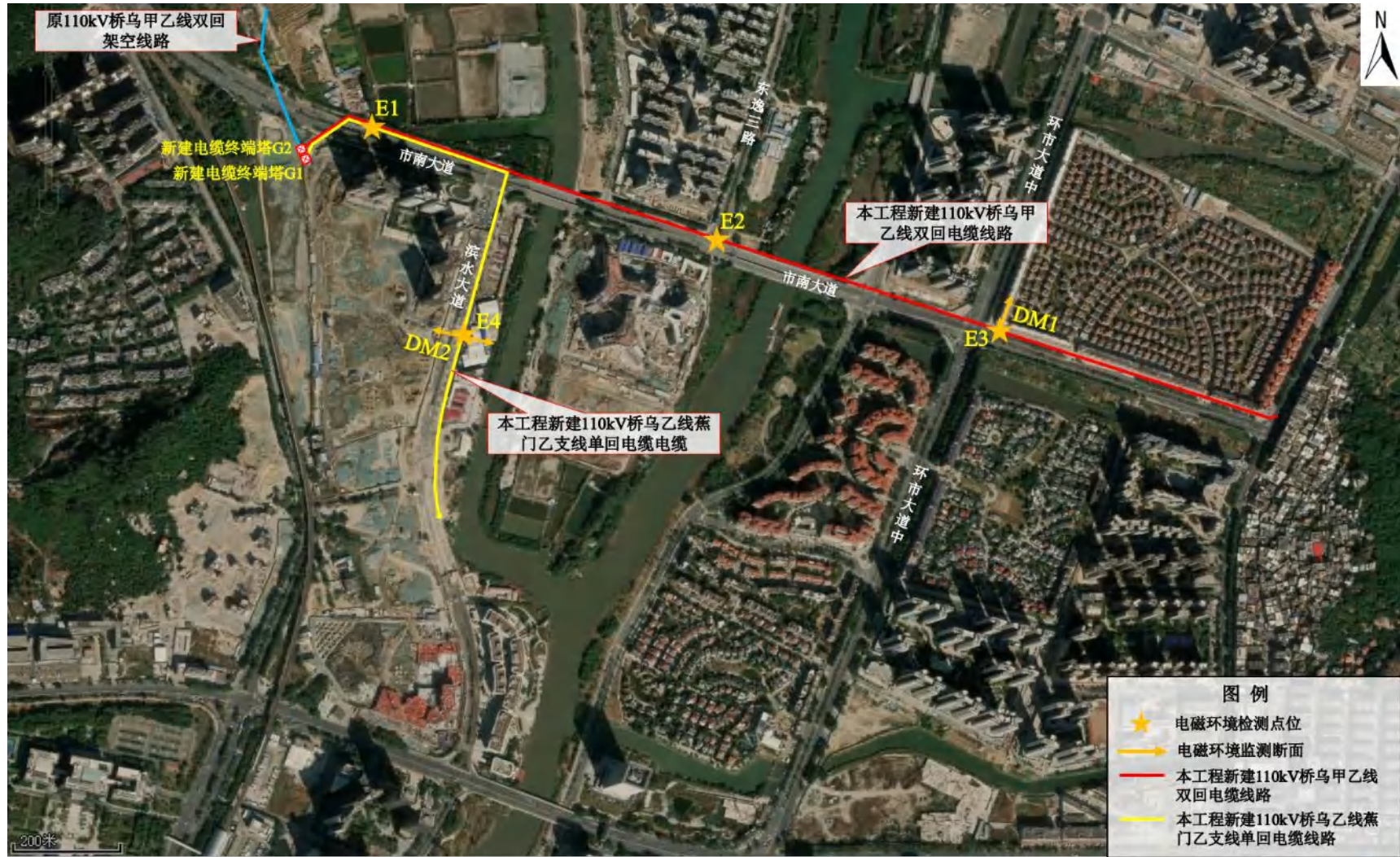
图I-7 110kV 类比电缆线路电磁环境监测布点示意图
