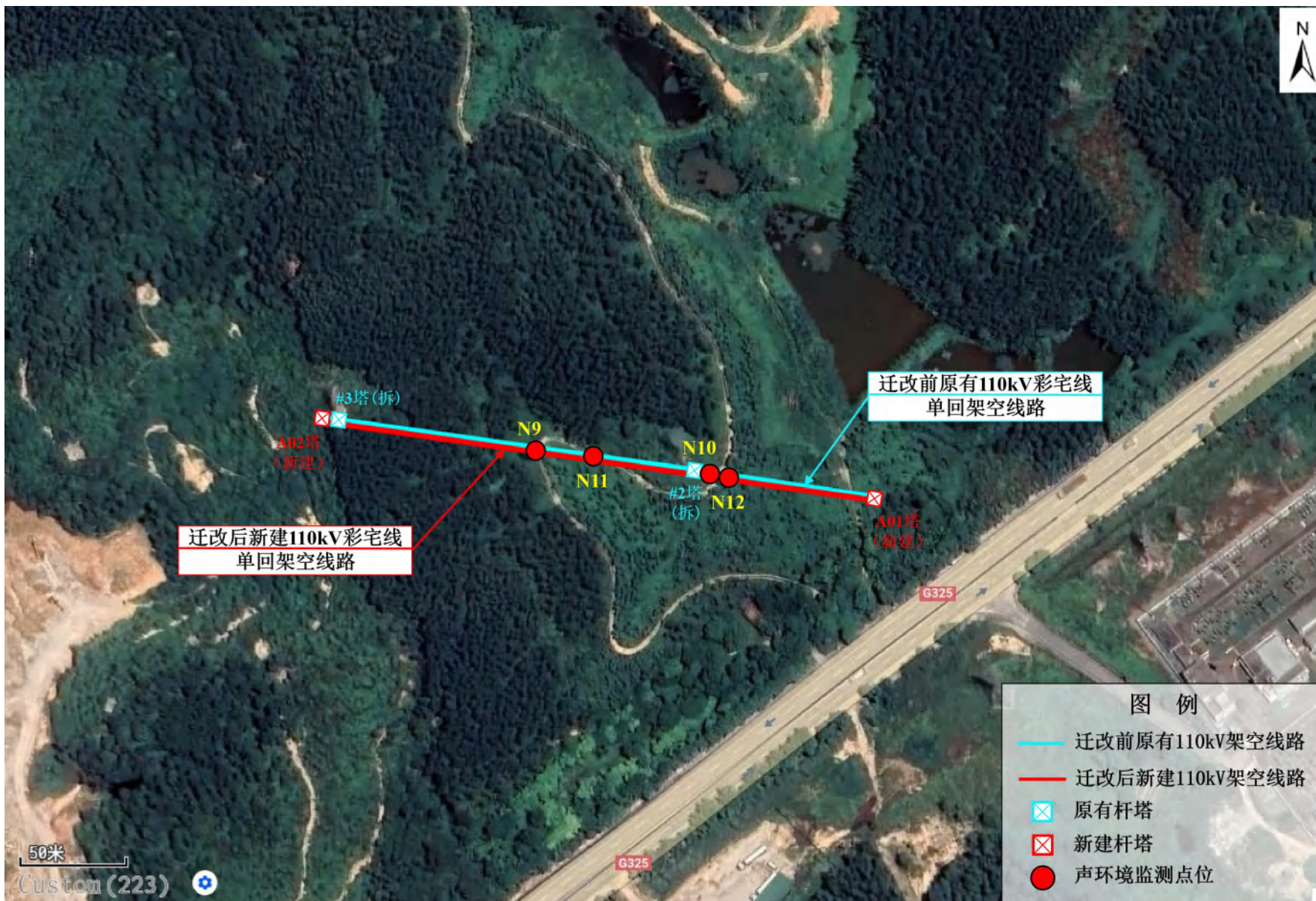
图 3-4 本工程声环境现状监测布点图-110kV 彩宅线#1~#3 段迁改工程
