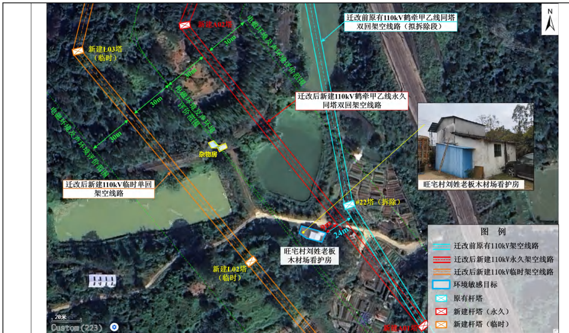
图 3-8 本工程迁改前后线路周围的环境敏感目标-110kV 鹤牵甲乙线#21~#24 段迁改工程
