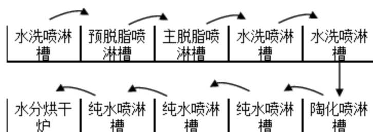
图 3.4-6 发动机八件套喷漆线前处理工艺流程图
