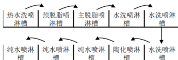
图 4.8-4 油箱生产线前处理工艺流程图
