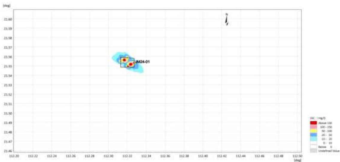
图 6.3.4-5 JM24-01 采砂区块施工增量悬浮泥沙最大浓度平面分布（表层）
