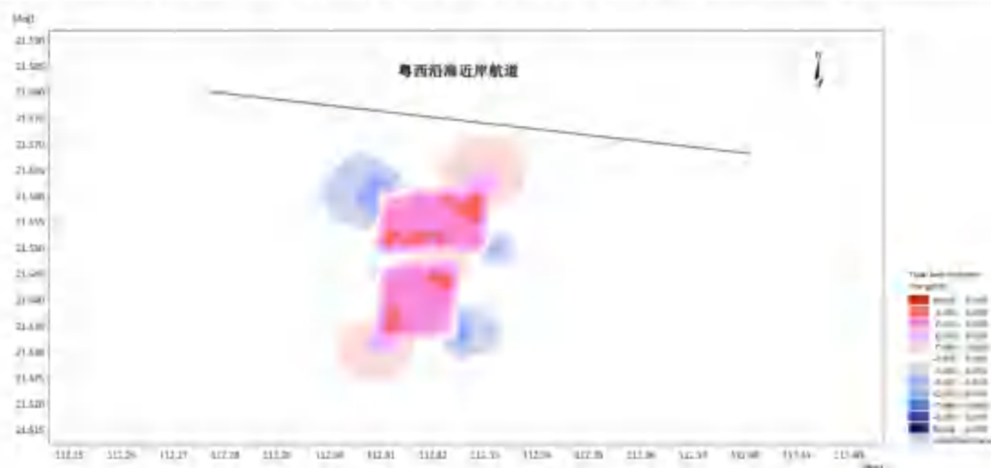
图 6.2.2-2 工程区附近海床年冲淤变化平面分布图（两矿区同时采砂）
