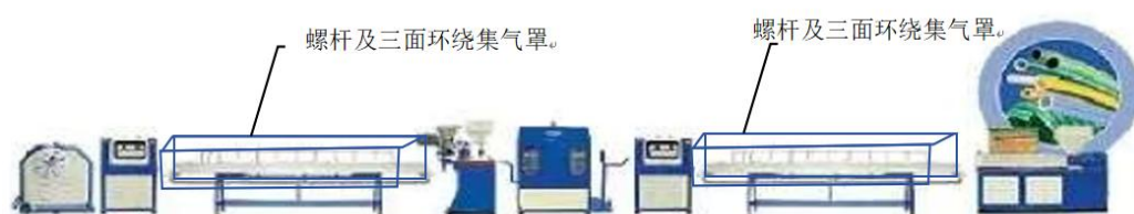
图 4-1 三面环绕的方式对螺杆末端进行半封闭处理示意图
