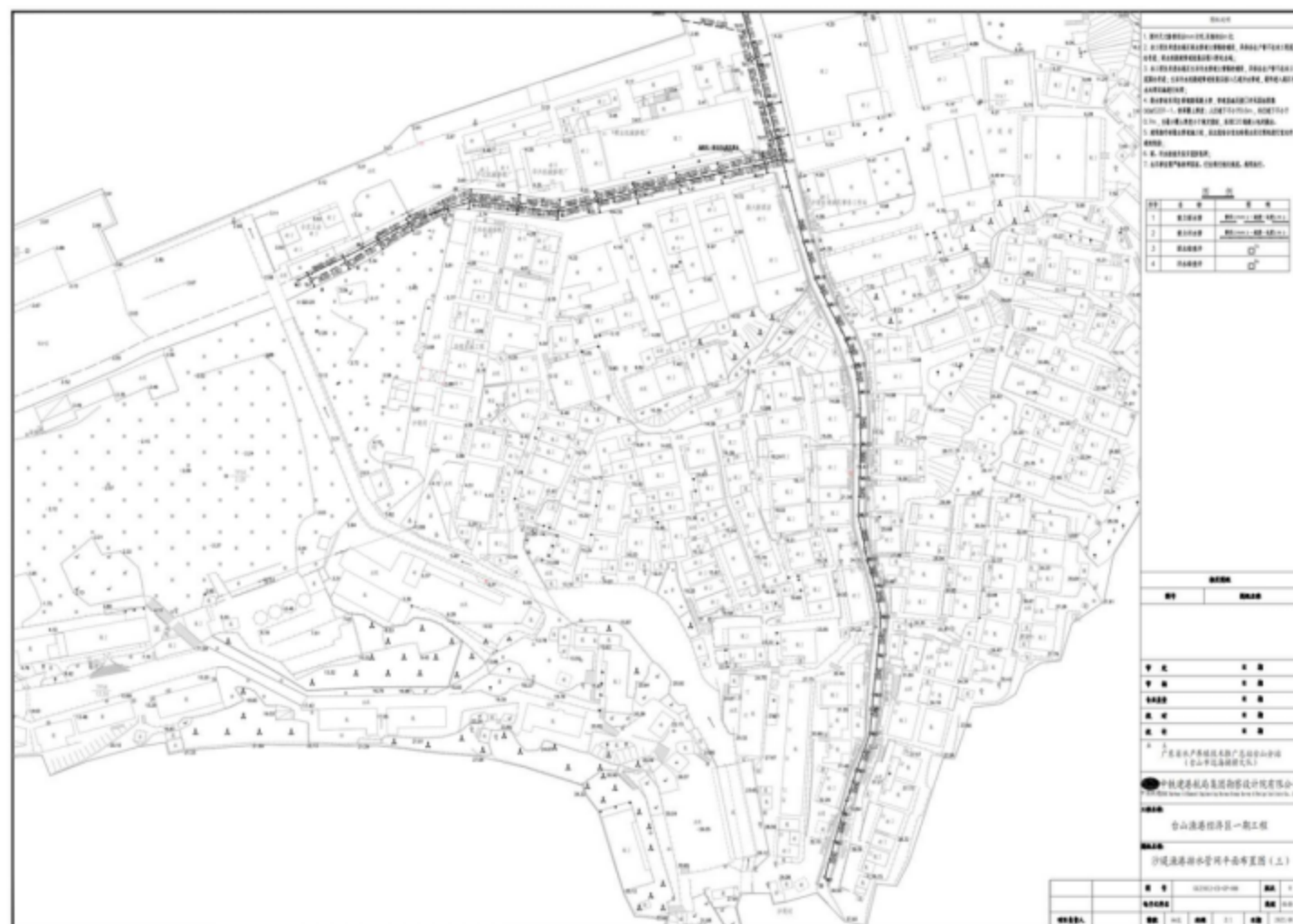
图 3.3.4-4a 沙堤渔港污水管网平面布置图
