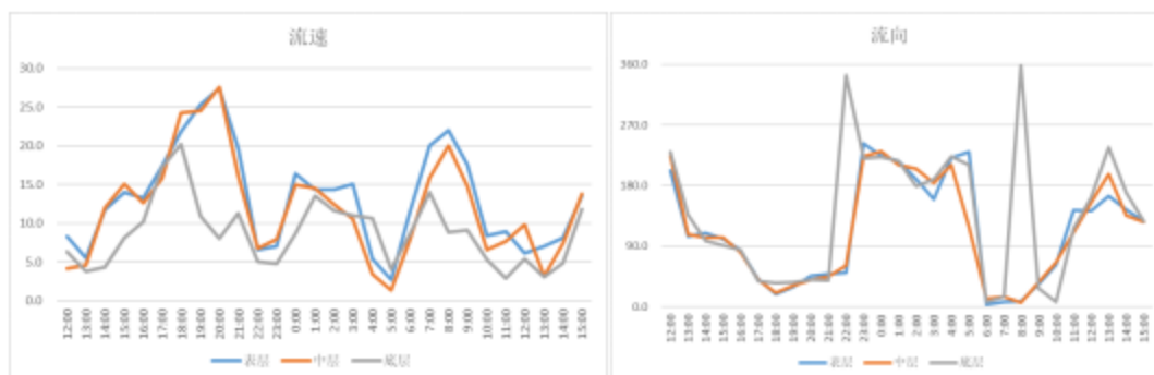
图 6.1.1-3c 海流矢量时间变化序列图 (S3 站)
