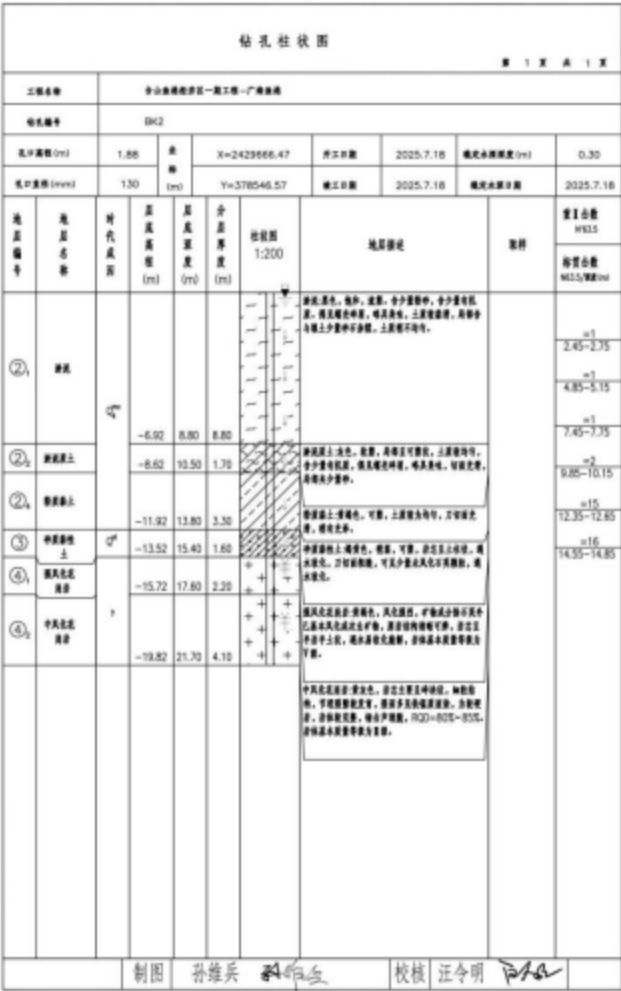
图 5.1.4-8a 广海渔港(烽火角港区)钻孔柱状图
