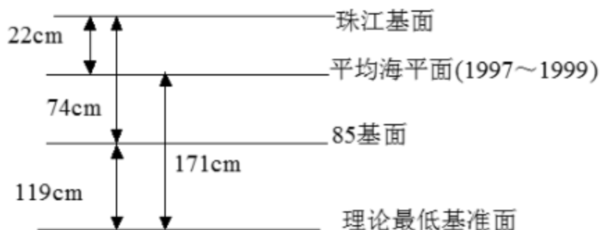
图 5.1.2-1a 基面换算关系示意图（镇海湾海域）
