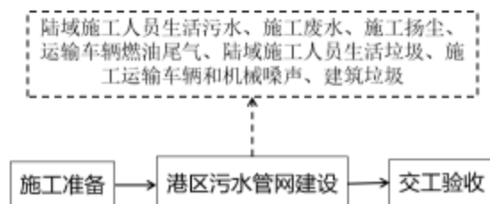
图 4.1.1-3 项目沙堤渔港施工过程主要产污环节示意图
