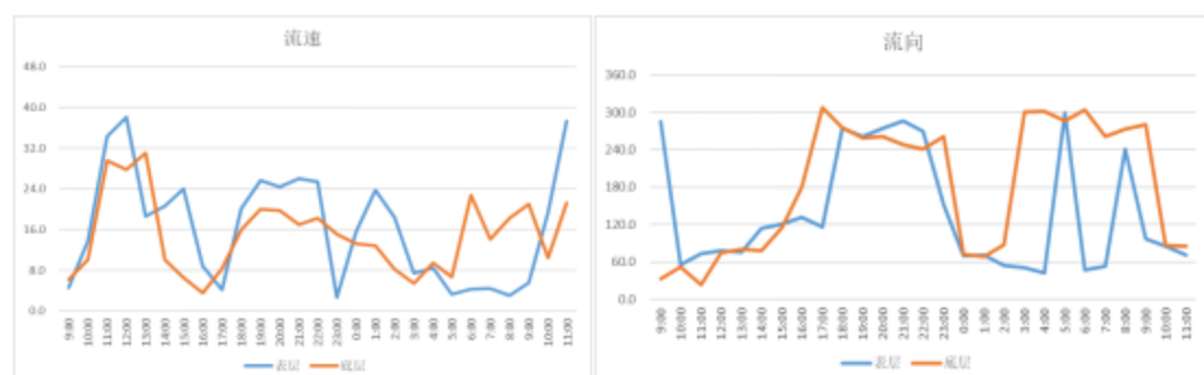
图 6.1.1-3e 海流矢量时间变化序列图 (S5 站)
