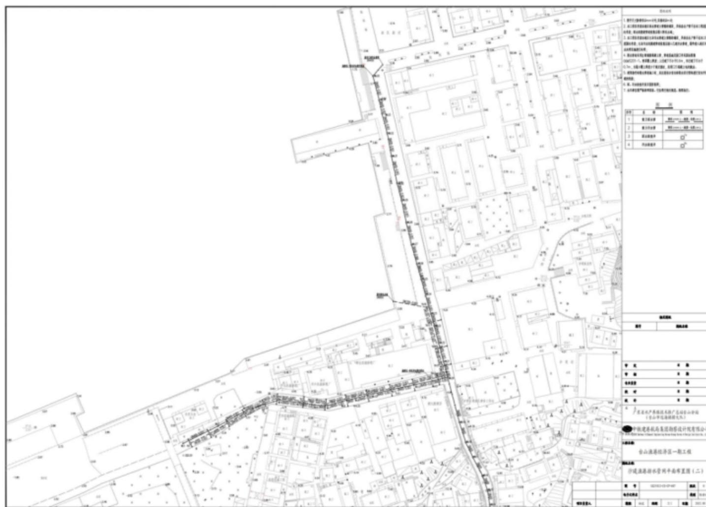
图 3.3.4-4a 沙堤渔港污水管网平面布置图
