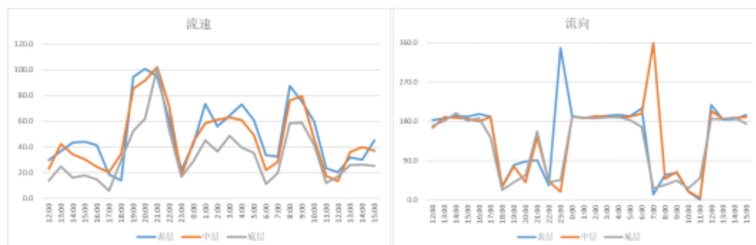
图 6.1.1-3a 海流时间变化序列图 (S1 站)
