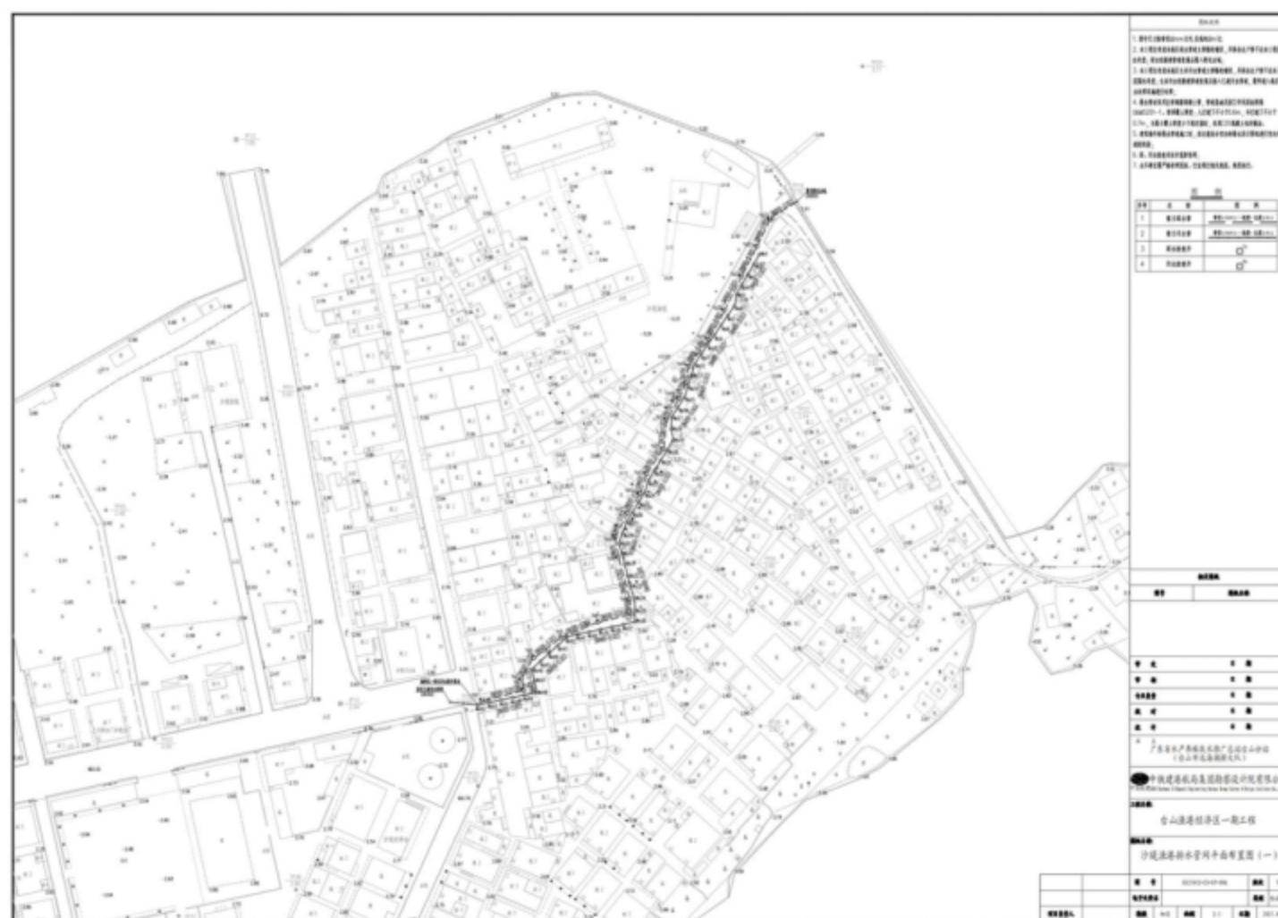
图 3.3.4-4a 沙堤渔港污水管网平面布置图
