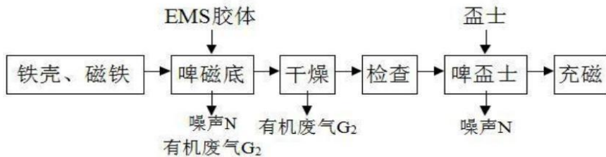
图 2-15 磁底段生产工艺流程及产污环节图
