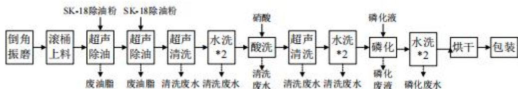
图 2-22 磷化工艺流程及产污环节图
