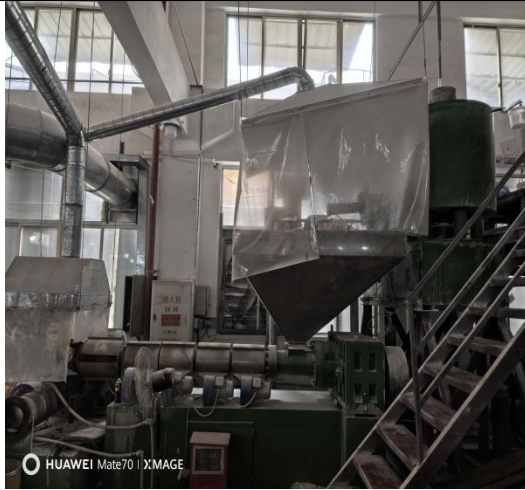
胶粒生产机投料口“集气罩”
