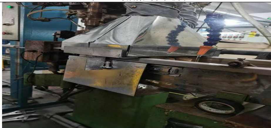
造粒机造粒成型口、挤出机挤出口“半密闭型集气罩”
