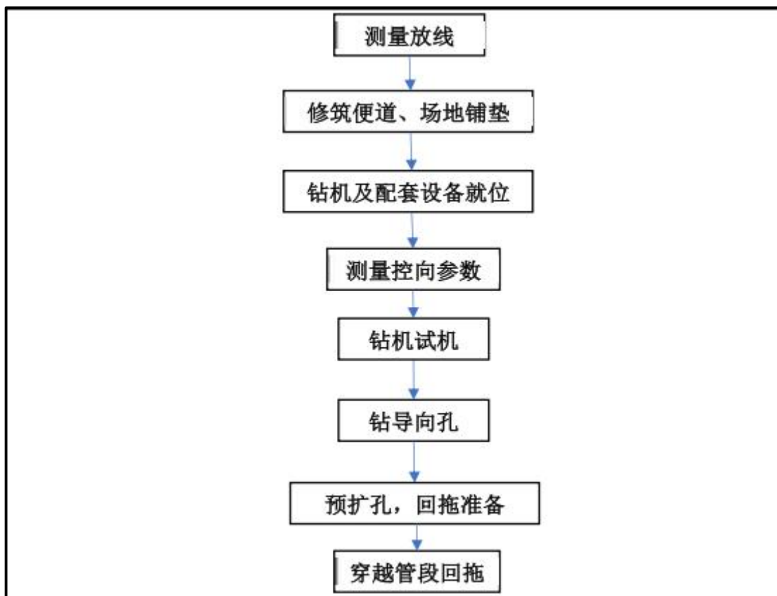
图 3.3-3 水平定向钻施工工艺流程图
