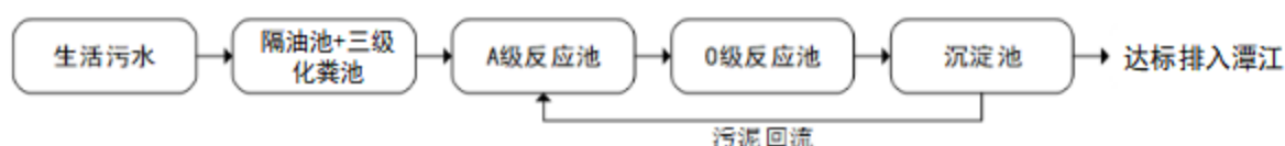
图 8.2-6 项目废水处理工艺流程图
