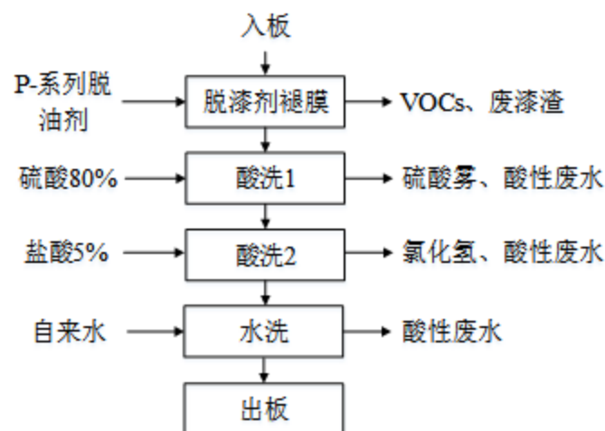
图 3.2-7 手动褪膜工段工艺流程及产污节点示意图
