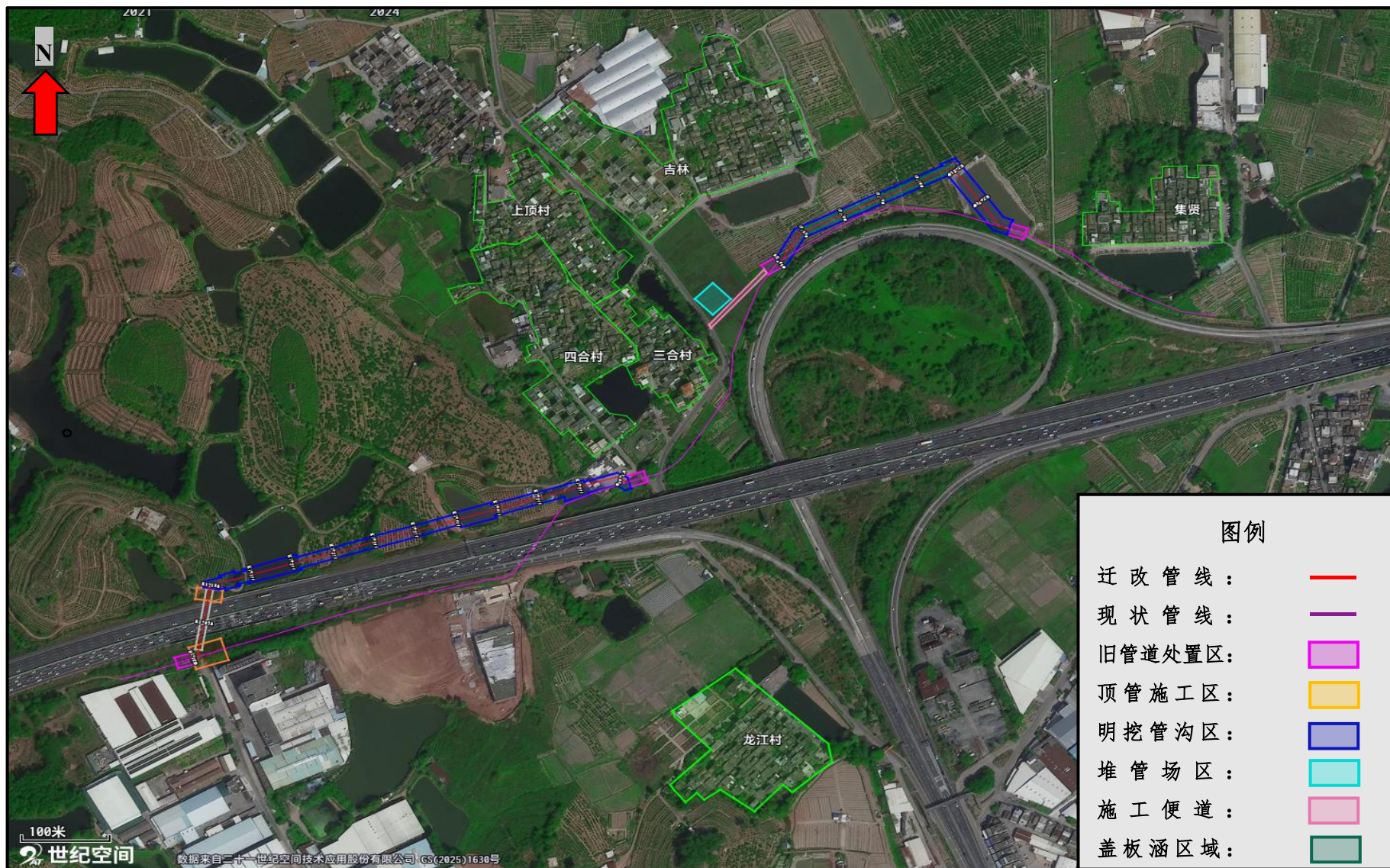
图 3.2-3 改线管道路由示意图（全幅图）
