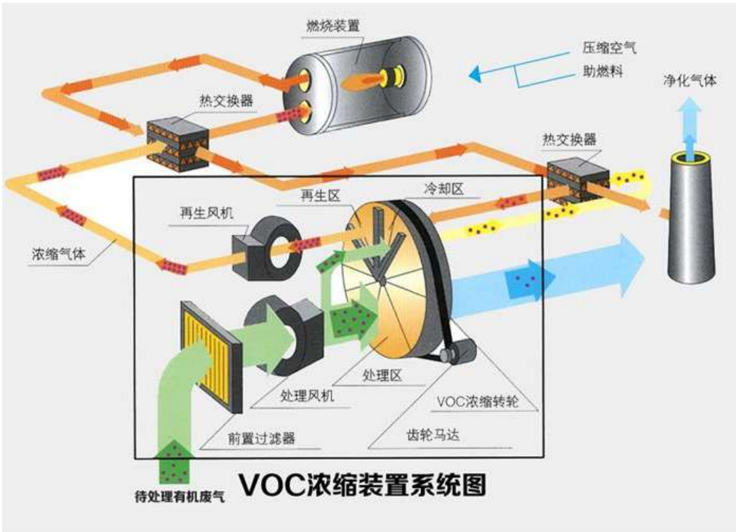
图9-1 吸附吹脱焚烧处置工艺流程图
