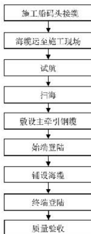
图 3.4.1-2 海缆敷设施工工艺
