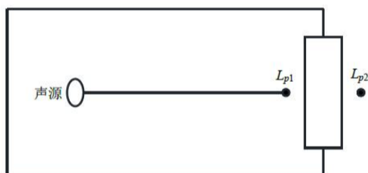
图 4-2 室内声源等效为室外声源图例
