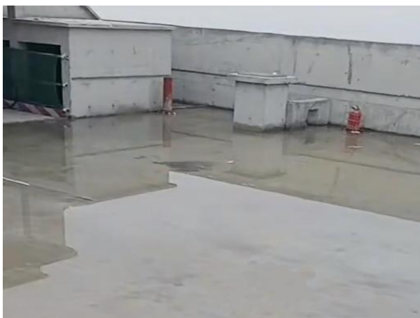
图1.4.2-1 【好】屋面结构闭水试验
