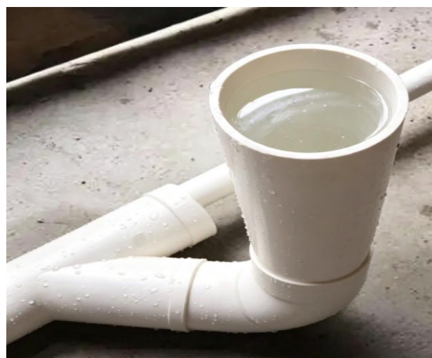
图3.1.1-2 【好】 隐蔽或埋地的排水管斜道灌水试验
