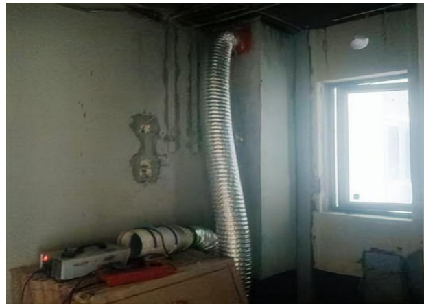
图3.2.1-4 【好】 排烟道进行打烟试验
