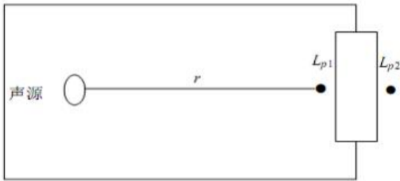
图43 室内声源等效为室外声源图例
