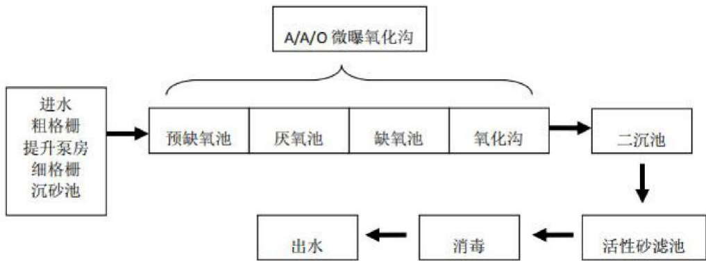
图 3. 开平市新美污水处理厂处理工艺流程图
