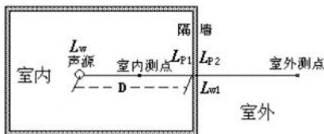
图 4-1 室内声源等效为室外声源图例
