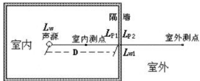
图 4-1 室内声源等效为室外声源图例
