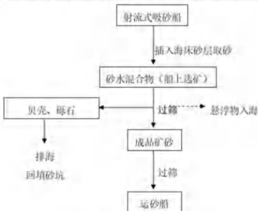
图 3.3.1-4 采砂工艺流程图
